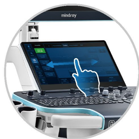
Tela de toque LCD de 13,3", alta resolução(1920x1080), controlada por gestos, antirreflexo
