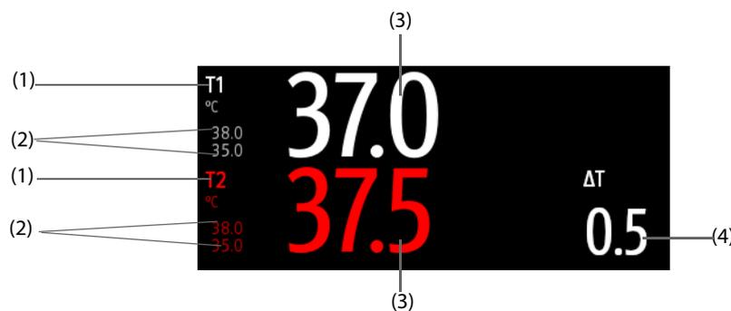
(1) Site de température      (2) Limites de l'alarme de température      (3) Valeur de température
