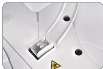
Каскадная промывка дозатора
