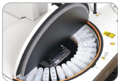
Автоматическое бесконтактное перемешивание реагента с парамагнитными частицами
