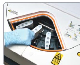
Автоматическое бесконтактное перемешивание реагента с парамагнитными частицами
