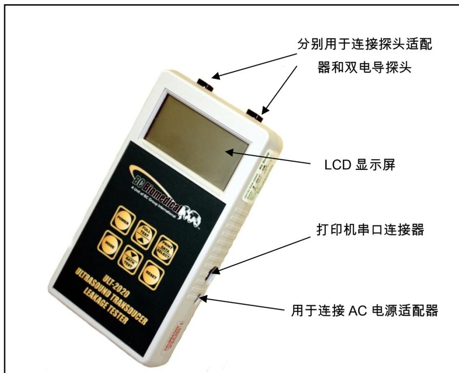
图2：漏电流测试仪
