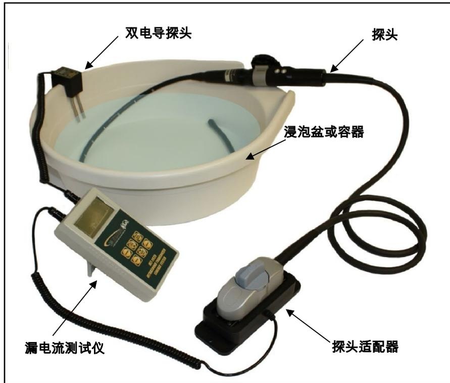
图1：典型漏电流测试仪装配
