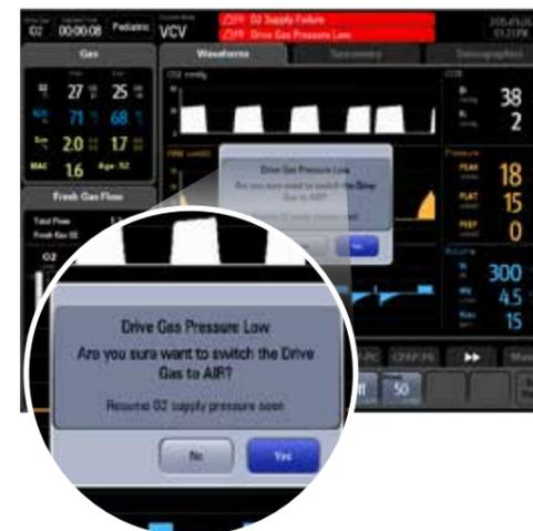
Damit der Patient zu jeder Zeit ordnungsgemäß beatmet wird, verfügt die WATO EX-65 über eine einzigartige automatische Umschaltfunktion bei Verlust des vom Beatmungsgerät ausgehenden Gases. Sollte das vom Beatmungsgerät ausgehende Gas nicht mehr verfügbar sein, schaltet das Gerät automatisch auf Luft (oder O<sub>2</sub>; je nach Gerätekonfiguration) um, ohne dass es zu einer Unterbrechung der mechanischen Beatmung kommt.
